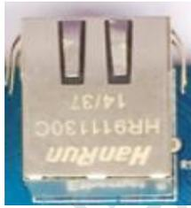
G6818 支持千兆有线以太网接口，板载 RTL8211E，用户可以通过有线以太网上网。
