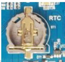
后备电池用于保证断电后 RTC 仍然能够工作，确保系统时间不丢失。当开发板接上锂电池后，将会给 RTC 供电，只要锂电池不掉电，RTC 就不会丢失，因此默认开发板不再提供 RTC 后备电池。
