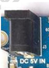
G6818 采用 5V,2A 直流电源供电，图中黑色插座为 5V 直流电源输入插座。
