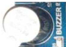
该蜂鸣器为有源蜂鸣器，有直流电时会鸣叫，通过三极管控制电源的导通与截止。硬件电路通过一路 PWM 控制三极管，即可以用于 PWM 测试，也可以用于适当场合的声音提示。
