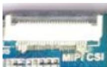
该接口为通用的 26PIN 摄像头接口，支持 OV，奇景等摄像头，省去 camera 转接板。针对不同型号的摄像头，只需按照摄像头的规格，调整一下输出电压就行了。
